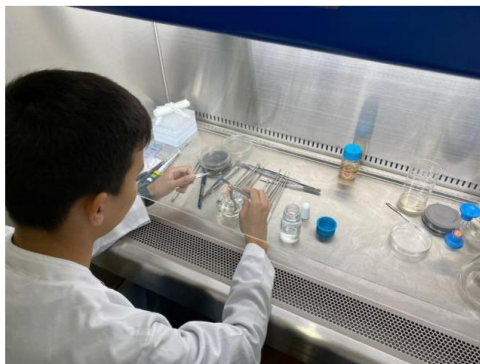
4 Сурет – Ламинарлы бокстағы құрал жабдықтарды стерилизациялау процесі
